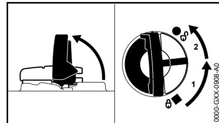
Levante la palanca y gire la tapa lentamente (1) a la posición de ventilación, aprox. 1/8 de vuelta, donde la tapa es mantenida en posición por la rosca. Una vez que los vapores se han aliviado, gire (2) la tapa más hasta la posición de 1/4 de vuelta, donde la tapa sin necesidad de herramientas puede ser retirada de la rosca del tanque.
