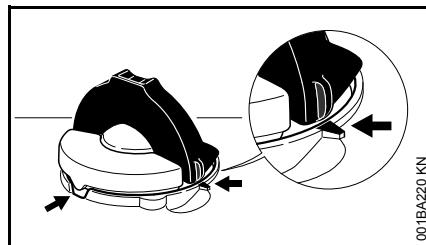
Para hacer esto con esta tapa STIHL, levante la empuñadura en la parte superior de la tapa hasta dejarla vertical a un ángulo de 90°. Inserte la tapa en la boca de llenado del tanque, alineando las marcas de posición en la empuñadura de la tapa y en la boca del tanque. Utilice la empuñadura para oprimir la tapa firmemente hacia abajo mientras la gira en sentido horario hasta que tope (aprox. un cuarto de vuelta).
