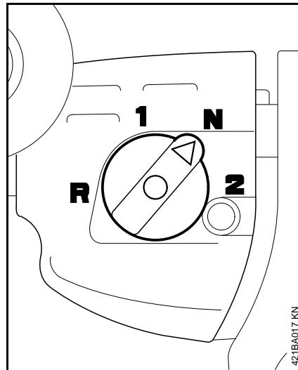
El taladro motorizado tiene una caja de engranajes que permite cambiar la velocidad. La velocidad puede ajustarse según la situación y la herramienta perforadora utilizada.
